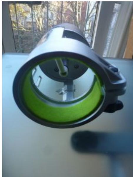
Den Adapter mit Matritze aufschrauben und den Abschneider aufsetzen und festziehen, das Messer muss an der Matritze anliegen.
