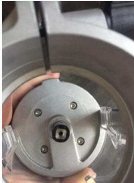
Diese kleine Schraube vorne abschrauben (mit einem Schraubenzieher T10 geht es am besten) und das Messer entfernen, dann den Dichtungsring drauf machen und das Messer wieder anbringen und mit der Schraube wieder festschrauben.
