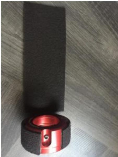
ungefähr 19 bis 20 cm Filz um den Adapter kleben , aufpassen das die Schraube frei bleibt. Der Filz sollte ca 5mm dick sein.
