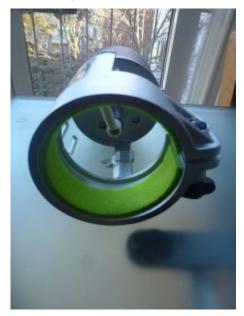
Den Adapter mit Matritze aufschrauben und den Abschneider aufsetzen und festziehen, das Messer muss an der Matritze anliegen.
